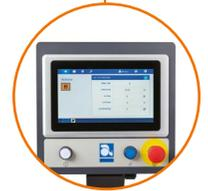
La pantalla de control AutoTouch™ permite acceder a tutoriales para el operador, sistema de ayuda, diagnósticos integrados y monitoreo del funcionamiento del equipo
