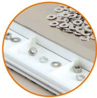
La cinta transportadora dentada garantiza la separación de las piezas y el transporte preciso y eficiente del producto hasta el sensor
